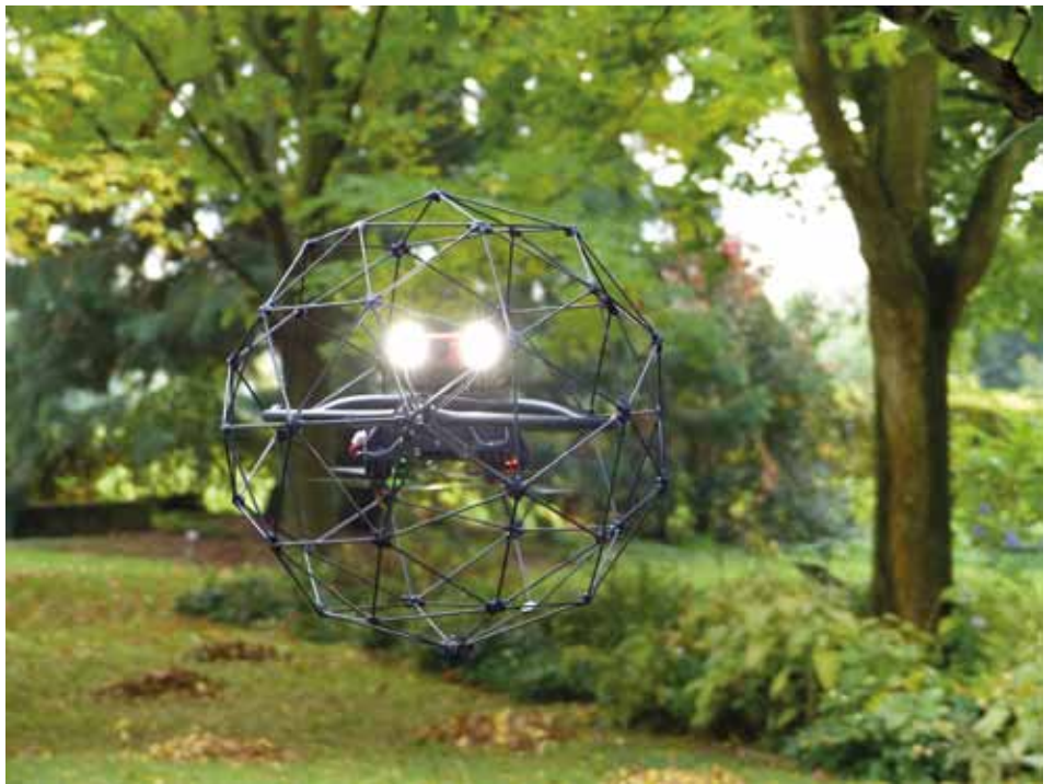
Een bolvormig koolstofframe beschermt de rotoren.
