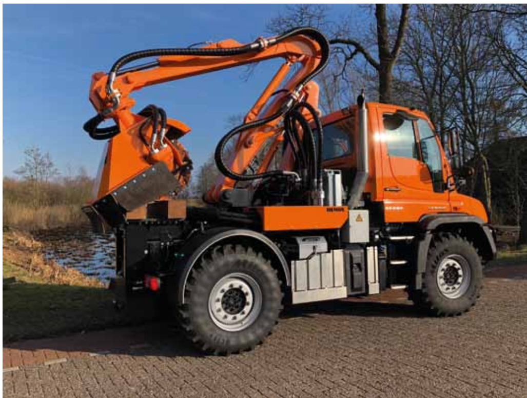
HemoS-stobbenfrees S850Z-350-355 Unimog: minder manuren op de weg en meer uren op locatie; een lichtere HemoS-stobbenfrees op een snelle Unimog-vrachtwagen
