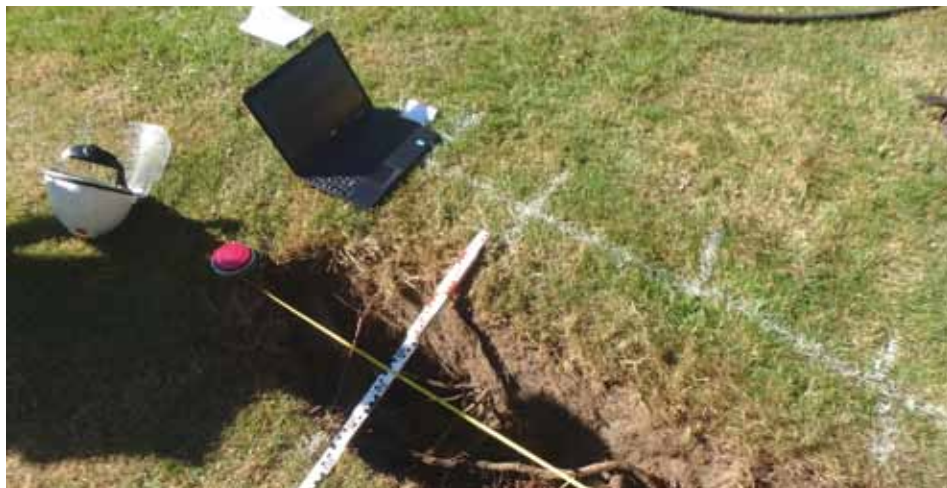
Locatie en worteldimensies werden nauwkeurig vastgelegd tijdens de grondradarproef in Utrecht.
