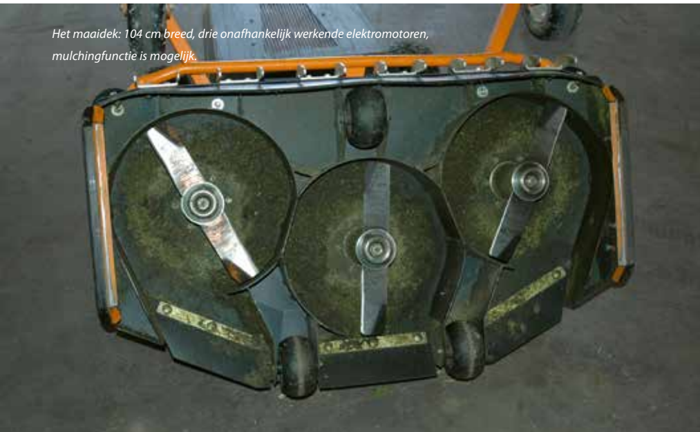
De maaihogte, 40-100 mm, is in zeven stappen verstelbaar. Vier geborgde pennen houden het zwevende maaidek op hoogte.
