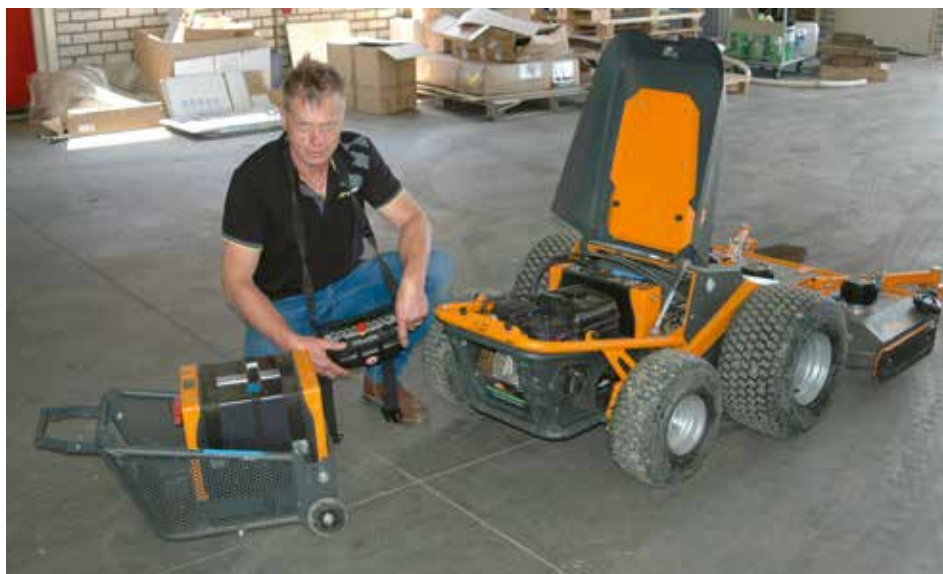
Links de power swap, louter bestaand uit een 50,4 V 120 Ah-accupack. Hiermee kun je tot acht uur elektrisch maaien. Verwisselen gaat snel.
