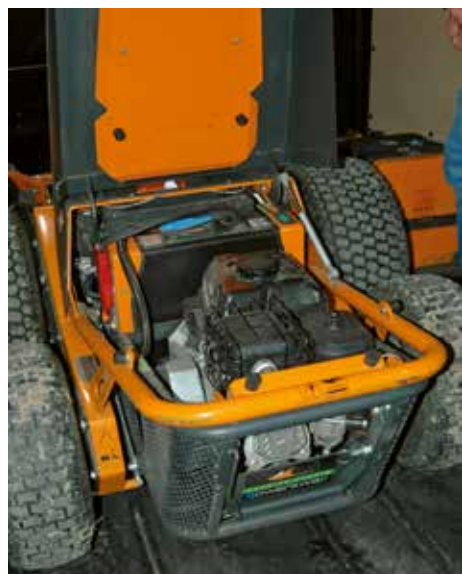
De hybride Raymo-maaier met de power swap waarin de B&S-motor, een generator en een klein accupack zitten.
