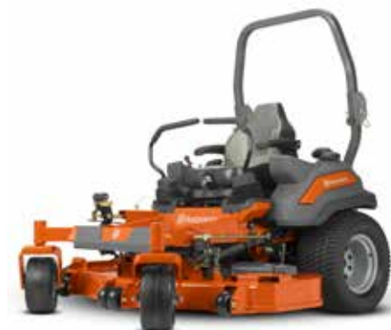
De Z560X maait met het 152 cm brede maaidek ruim 2,3 hectare per uur. De topsnelheid bedraagt 19,3 km/h.
