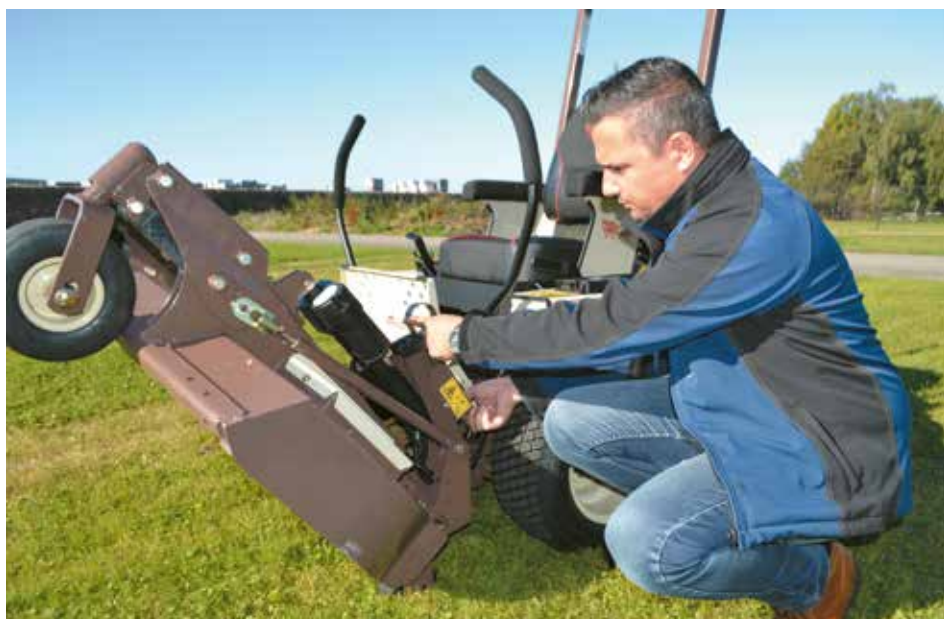
Er is geen gereedschap nodig om met het Grasshopper-powerfold-systeem het frontmaaidek verticaal te stellen.
