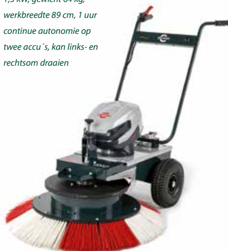
Cramer WKB480-onkruidborstelmachine. Vermogen 3,3 kW, gewicht 57 kg, werkbreedte 48 cm, verstelbare schuinstand, opklapbaar spat scherm
