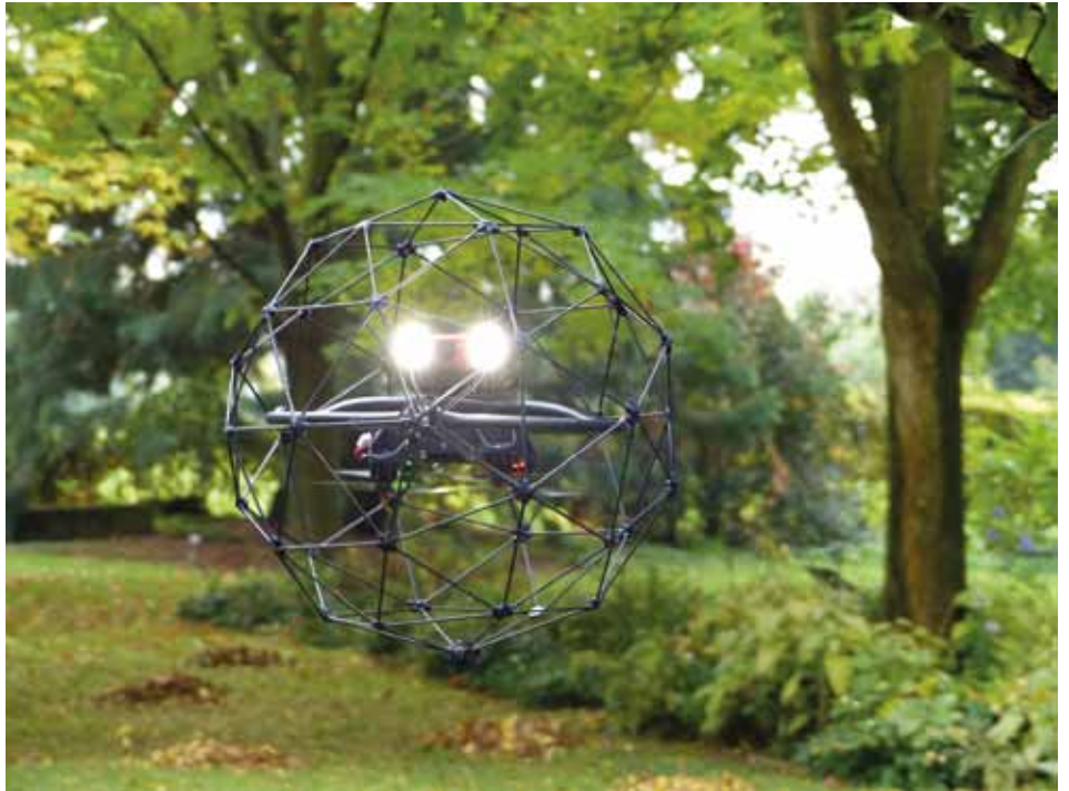
Een bolvormig koolstofframe beschermt de rotoren.
