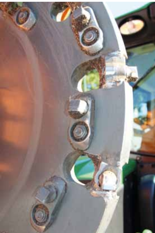
Bij de beitelopbouw is uitgegaan van de opbouw op het wiel van Dura Disk.
