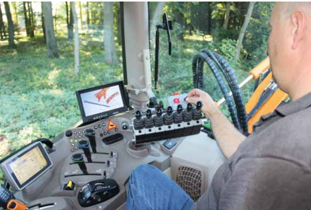
Met het bedieningspaneel van Linde kan Blauwendraat het toerental van de frees zelfstandig regelen.
