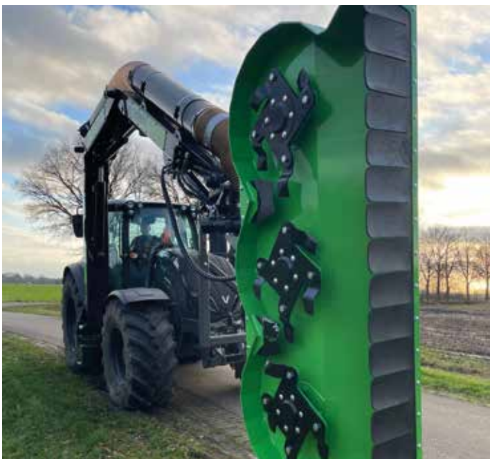
Vier verschillende typen slagmessen op één rotor
