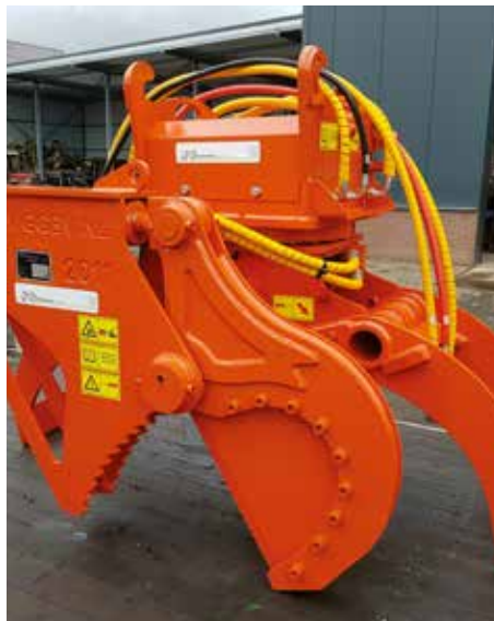
De op één na zwaarste aanbouwknipmodule van de GG-hydraulische knipschaar (Groeneveldt Grijpers)
