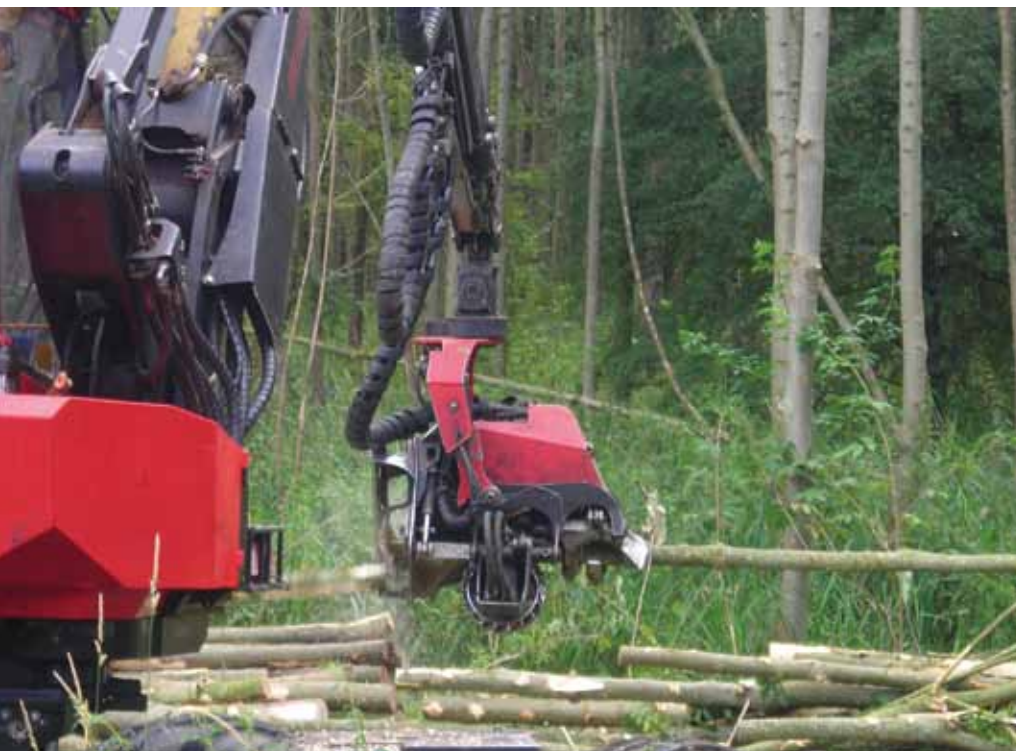
Sensoren bepalen exact op welke stapel het gezaagde hout moet worden gelegd.
