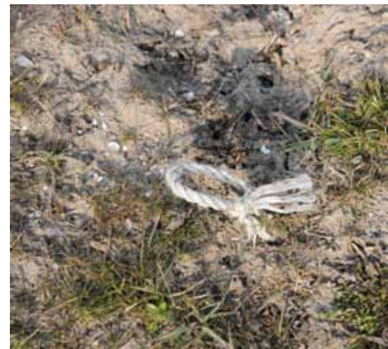
Resten van de kluitverankering steken boven de grond uit. Het touw wordt ondergronds verteerd door micro-organismen. Bovengronds gaat dat veel langzamer in verband met het bijna niet aanwezig zijn van micro-organismen. De afbraak verschilt per locatie, afhankelijk van grondsoort, vochtigheid, aantal micro-organismen etc.
