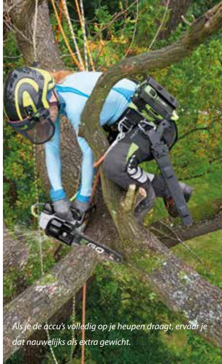
Na inschakelen zijn er twee aparte handelingen aan het handvat nodig voor het deblokken en om de ketting te laten lopen/gas te geven. Dit vergroot de veiligheid.
