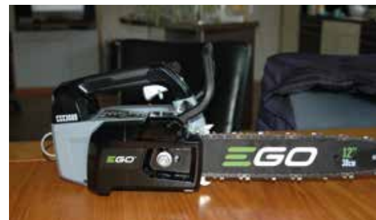
Na inschakelen zijn er twee aparte handelingen aan het handvat nodig voor het deblokken en om de ketting te laten lopen/gas te geven. Dit vergroot de veiligheid.
