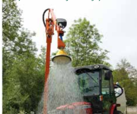
Gietarm met de optionele elektrisch verstelbare broes. Een hydraulische verstelling is ook mogelijk.
