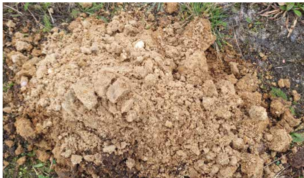
De grond kon worden opgewaardeerd en hoefde niet te worden afgevoerd.
