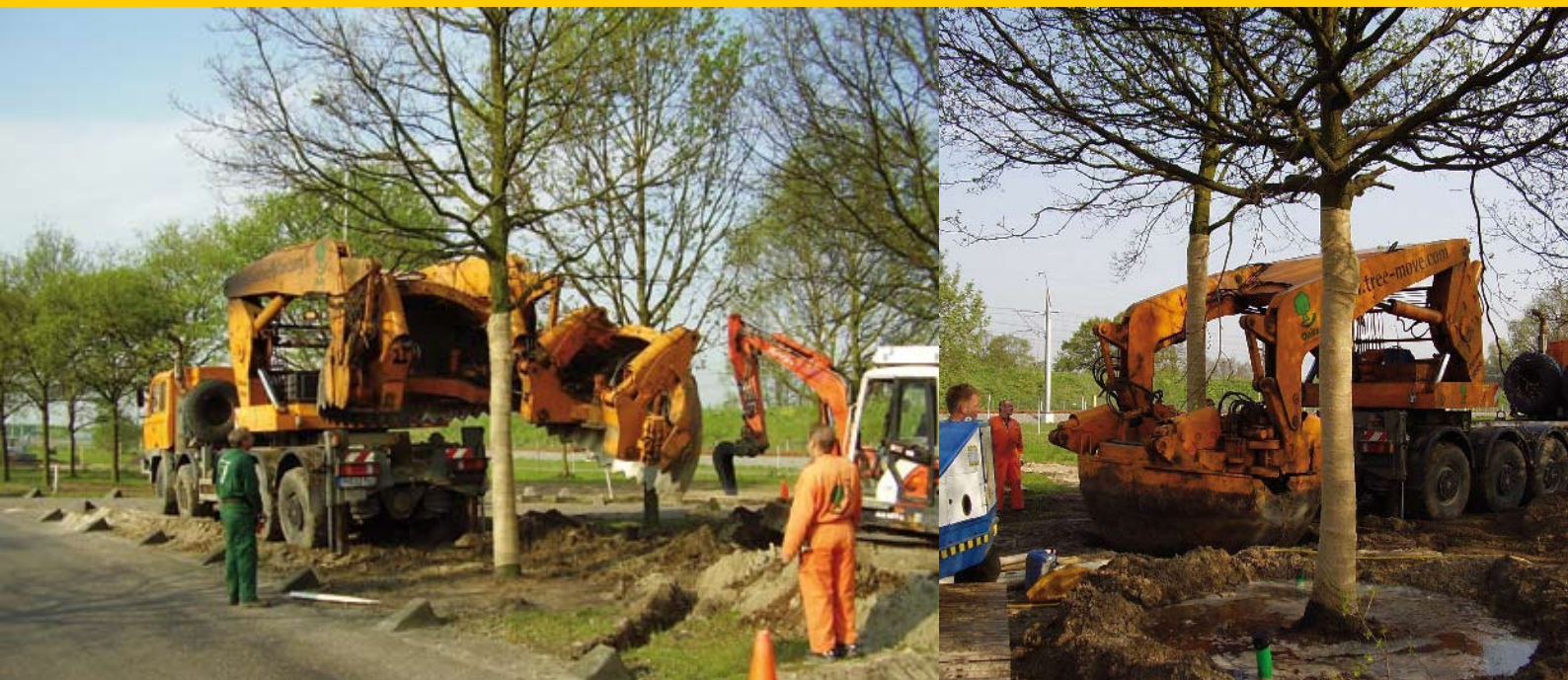
De verplantmachine: de machina graaft de boom met kluit en al de grond uit. Bron: Nationale Bomenbank
