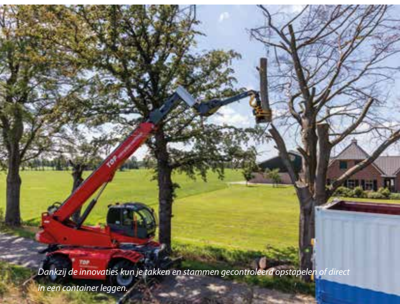
Met Gierkink's velkop gemonteerd achter een kraanwagen is werken in de stad gemakkelijk en veiliger.
